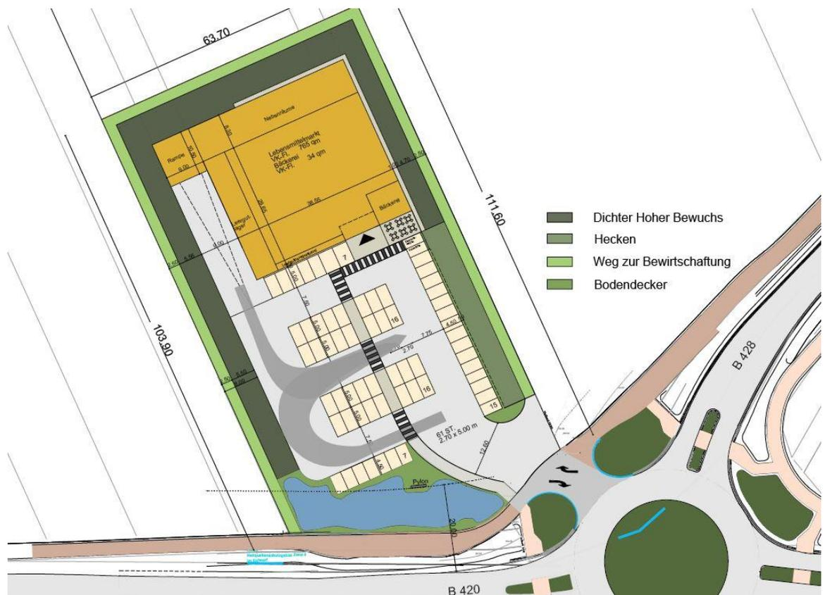
**Abbildung 7: Schleppkurvennachweis (Bemessungsfahrzeug LKW 3-achsrig, Länge = 10,1 m; Abbildung unmaßstäblich)**
