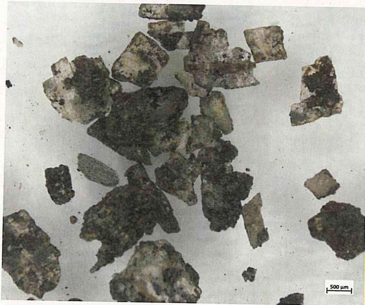
Abb. 6 Probe 80057 Autigen gebildete Calcitkristalle
